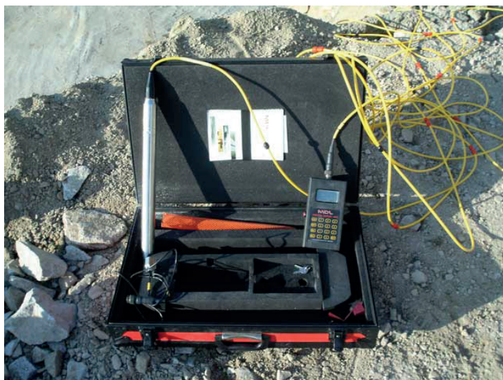
Rys. 4.2. Urządzenie do pomiaru odchyłeń otworów strzałowych [5]
